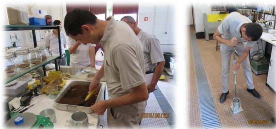
9-расм. Грунтларни оптимал зичлигини снқлаш жараёни
